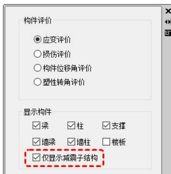
18.7 在变形指标-应变中输出单元的钢等效塑性拉、压应变
