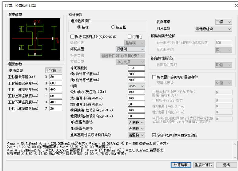
图 5.5.1-2 压弯、拉弯构件
