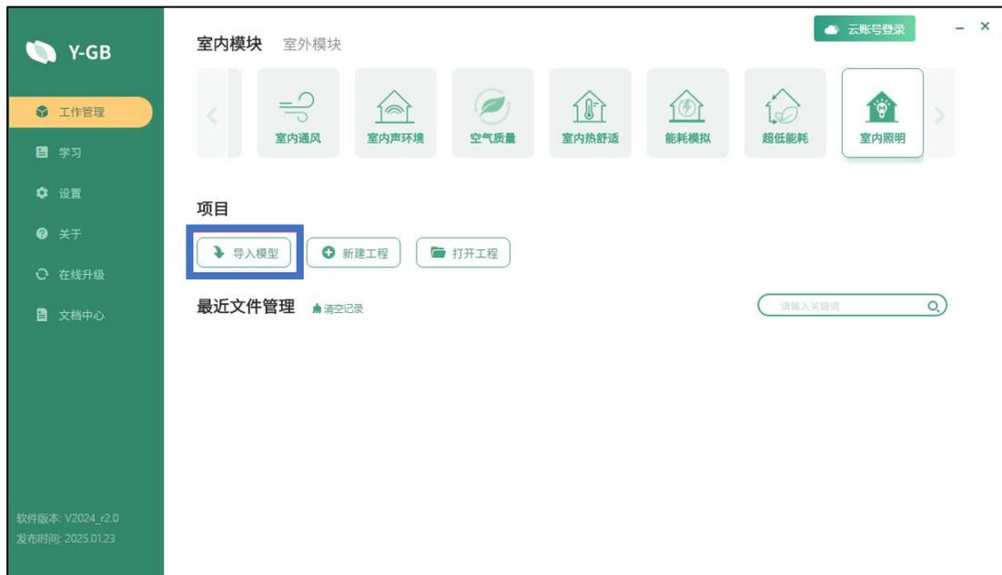
在弹出文件选择框底部，选择【.yxml】格式，找到导出的 BIM 模型文件，打开即可完成模型导入；
