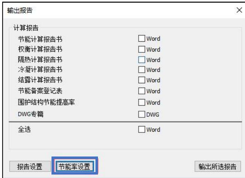
可依据计算要求，在其中勾选【相对节能率】（为设计建筑相对满足国家现行节能设计标准的建筑节能率）与【节能率】（为设计建筑相对于 20 世纪 80 年代建筑，即基准建筑，的节能率）。
