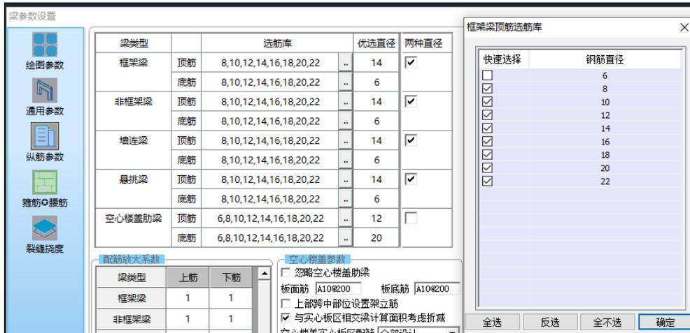
下图梁钢筋在导入后，可以看到，支座处的原位标注有些没有显示出来，如左上方的  $2\phi 25$  等。这就是因为用户按 HPB300 识别，而软件不支持 25mm 的直径，故含有  $\phi 25$  的梁标注均未识别出来。
