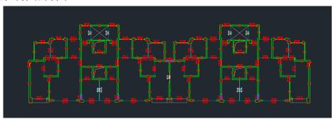
程序按照《建筑结构荷载规范》H.2.2 进行横风向风振等效风荷载标准值计算。模型路径下yjkwindforce 文件,可以看到,模型顶层该值高达82kN/m2,是正常情况的一百多倍,明显不合理。如下图:
