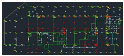
经检查,用户参数当中对地下室也进行了  $0.2\,V_0$  的调整,查看某根超限梁的构件信息, $0.2\,V_0$  调整系数异常大:
