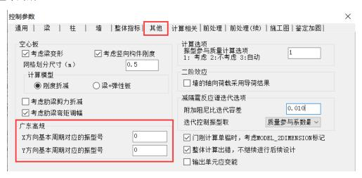
手动将上述案例高级参数基本周期对应振型号改为 1 之后,地震剪力调整系数则按剪重比调整,剪力墙不再超限。
