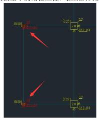
将其设置为不调整构件,让主体框架柱承担薄弱层调整,立柱配筋结果会更合理:
