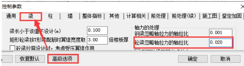
当轴压比超过【受弯构件按压弯设计控制轴压】限值时，程序会参考柱子的压弯公式对梁进行设计。
