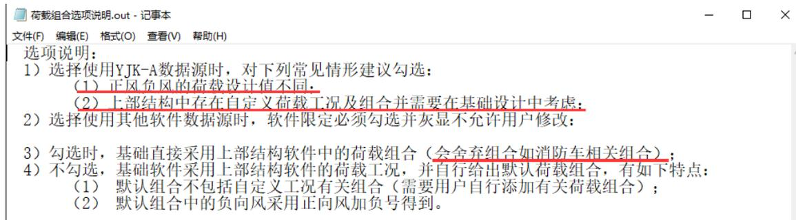
我们可知, 读取 YJK-A 荷载组合主要用于正负风荷载设计值不同的情况, 以及如工业结构自定义工况较多
