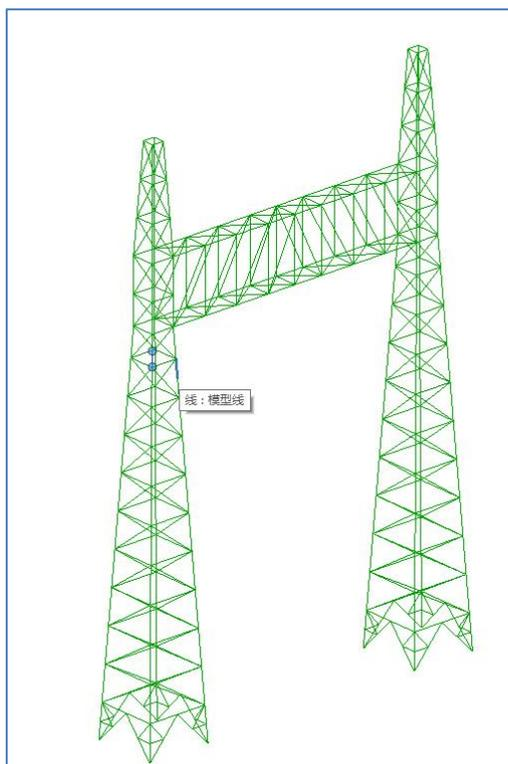
图 2.4.8 变电构架离散模型导入
