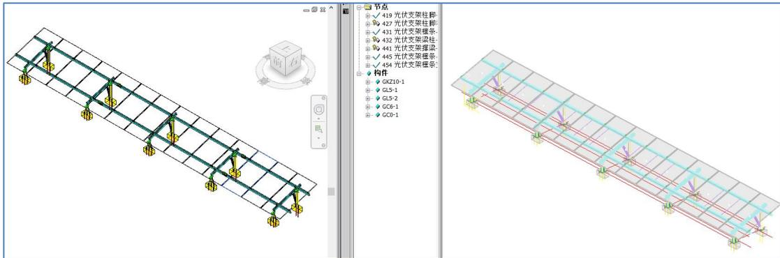
图 2.3.8 屋面三角桁架
