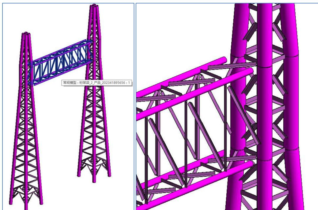
图 2.4.10 变电构架产品模型导入
