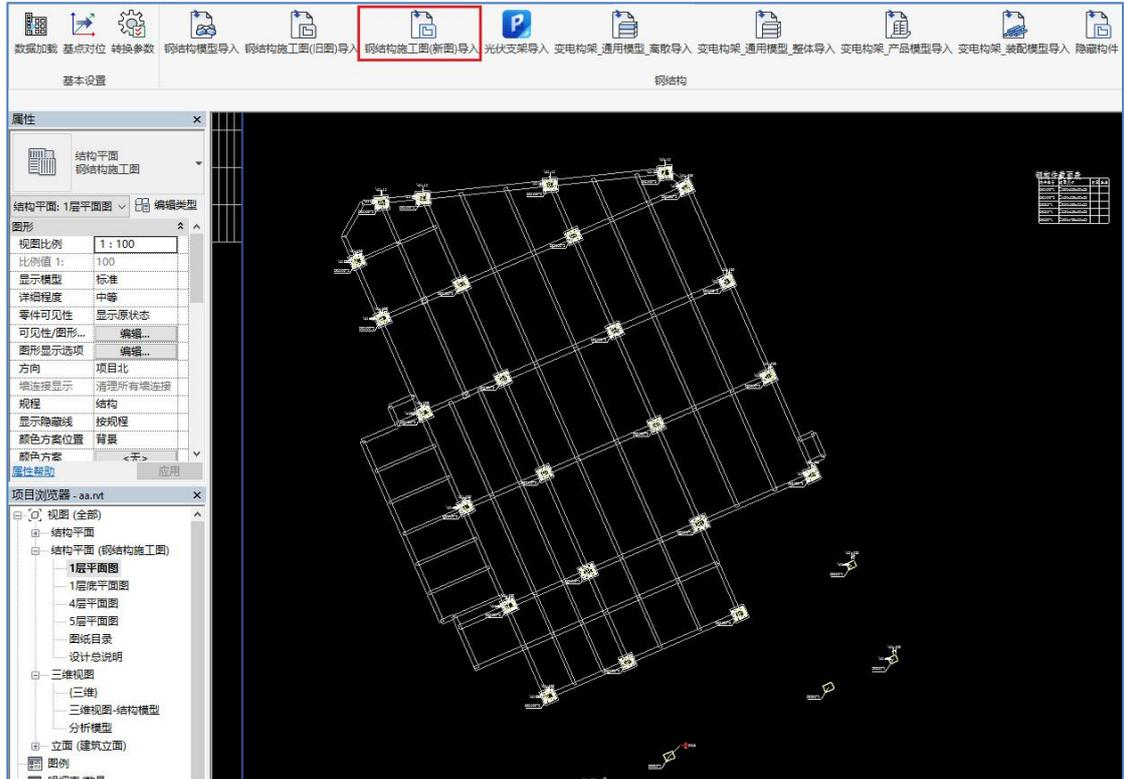
图 2.2.11 钢结构施工图（新图）导入
