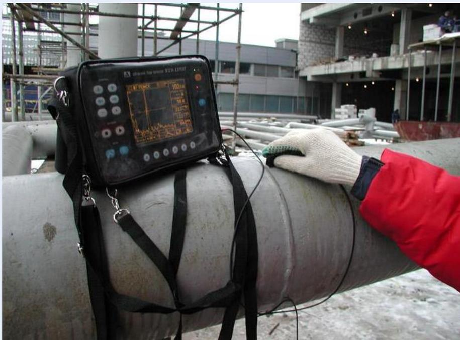
5.2.4 设计要求的一、二级焊缝应进行内部缺陷的无损检测，一、二级焊缝的质量等级和检测要求应符合表 5.2.4 的规定。
