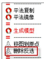
删除反选的主要功能是保留已选中的图素，将未选中的图素删除。将与转图无关的图素删除，可以提高软件的运行效率。
