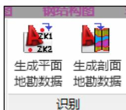
平面图用于直接导入 CAD 中的孔点平面信息，剖面图用于将地勘单位提供的孔点剖面图中的土层信息，包括土层主层号、亚层号及标高等信息导入 YJK 地质资料中，并可在孔点编辑中查看和修改导入的结果。
