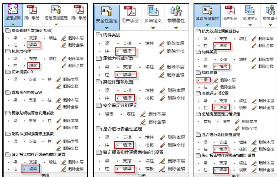
查找鉴定报告中墙洞连梁的构件编号可在安全性鉴定下构件编号简图中查看，鉴定报告中输出的编号为括号之前的编号，如下图中的8（括号内为墙洞连梁内部编号）。
