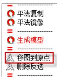
图纸距离原点过远，会导致图素显示变形，生成模型异常等现象。在转图前，需要将图纸移到原点附近。
