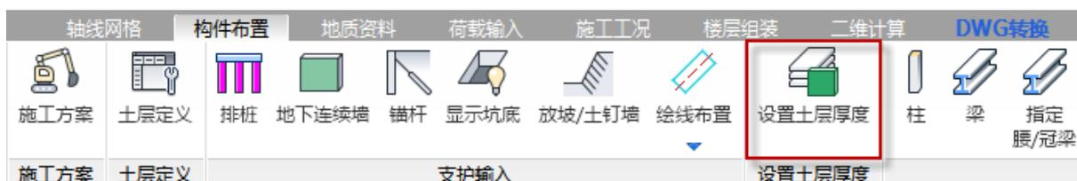
当【土层定义】中没有导入地质资料时，则【设置土层厚度】中应用地质资料按钮为灰显状态，用户只能手动布置土层厚度，如下图所示：
