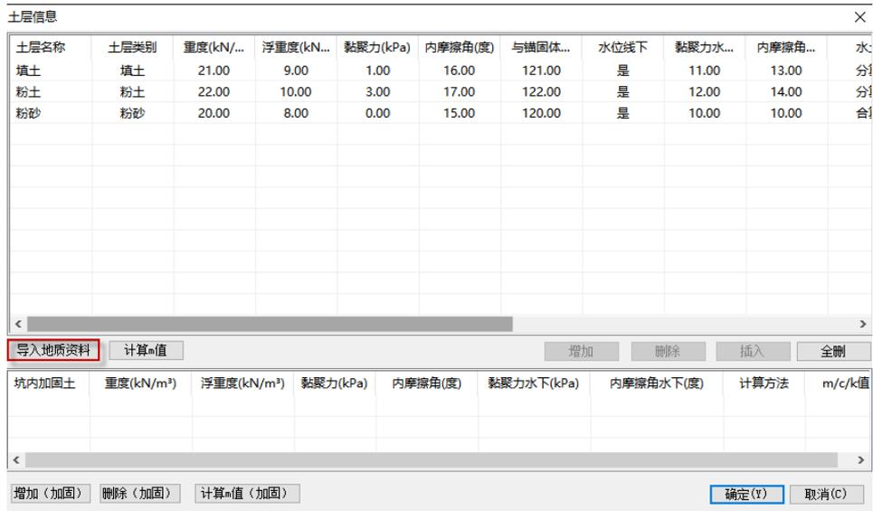
点击导入地质资料，会弹出导入对话框，选择要导入的地质资料文件后，点击打开即可。同时增加、删除和插入按钮灰显，用户仍可编辑导入的地质资料参数。
