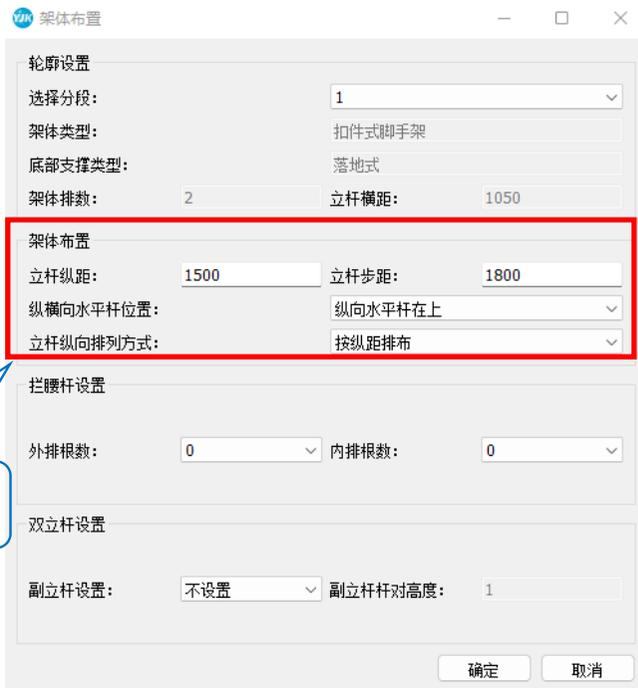
主要设置立杆、纵横向水平杆设计参数与排布构造
