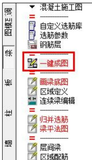
执行该命令后弹出下图所示对话框，在对话框中可以选择需要绘制平法图的楼层（可以按自然层选择，也可以按钢筋层选择），同时在该对话框中还结合了各个模块下“归并选筋”对话框的部分功能，实现了YASD自动一键成图。
