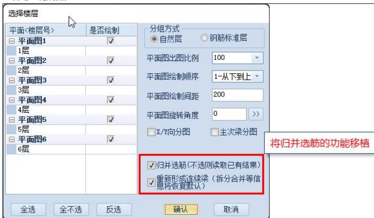
原底图绘制、归并选筋、绘制平法图的分步操作功能依然保留，因为在部分使用场景下无法通过一键成图来实现。比如底图绘制可以结合区域定义使用，实现分区域绘图；使用用户模板图结合计算数据绘制平法施工图时，可以在用户模板图的基础上导入YJK数据，然后执行归并选筋及平法图绘制。所以“一键成图”仅适应于直接使用YJK数据自动生成平法施工图的场景。
