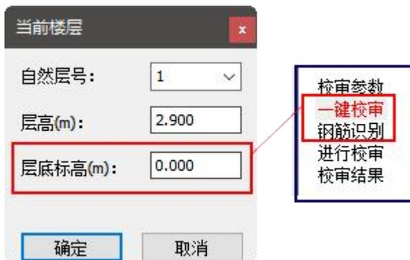
以下图所示的柱表为例，KZ2对应三个不同标高段的配筋，当钢筋识别设置了层底标高时，程序会根据层底标高与层高计算一个高度范围，该范围在哪个标高段内，则取该标高段对应的配筋。
