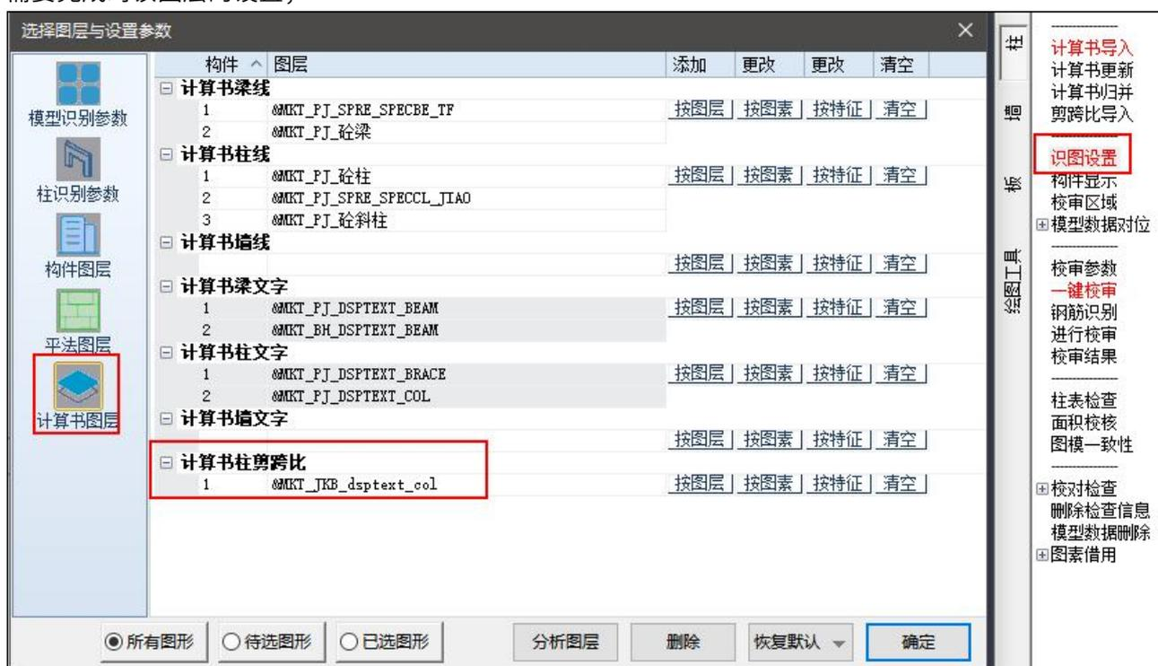
最后，在进行“一键校审”或“钢筋识别”时，可以同时完成对计算简图、剪跨比、平法标注的各项信息识别。所以剪跨比无需单独识别，操作简单。
