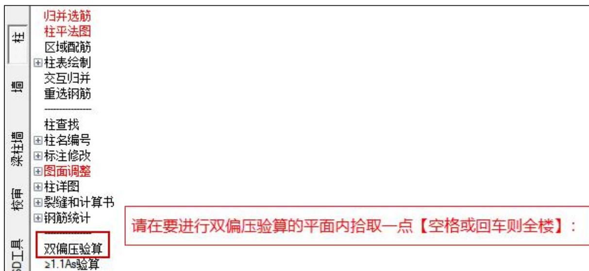
柱双偏压验算时可以仅指定一层查看双偏压验算结果，也可以直接回车同时完成全楼柱的双偏压验算。
