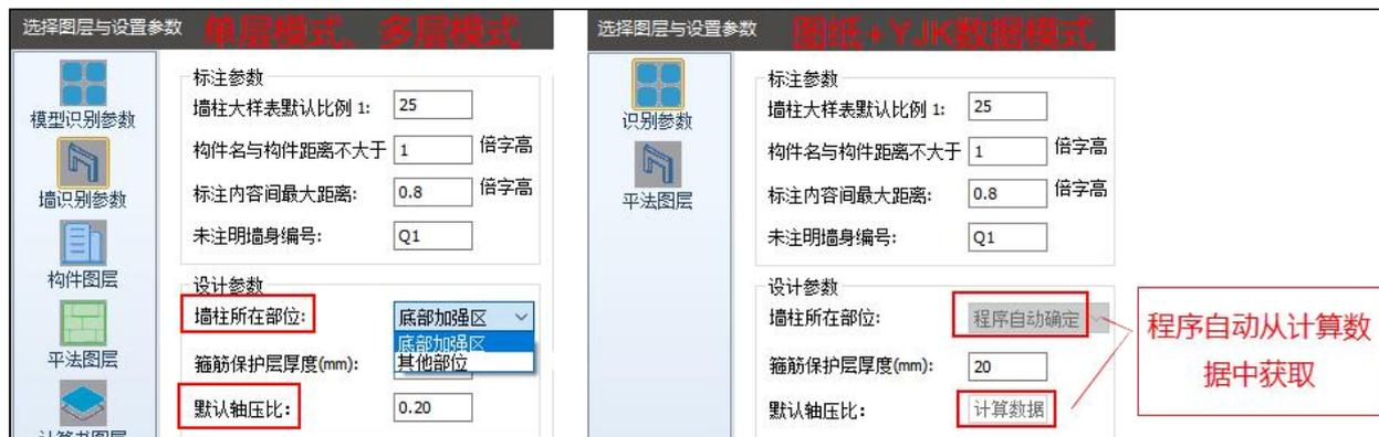
单层或多层图纸模式下，由于缺少基本的模型数据信息，所以在进行墙柱校审之前需要手动设置墙柱所在部位及默认轴压比，而“YJK数据”模式下，这些信息都不需要手动设置，程序自动从计算数据中获取。
