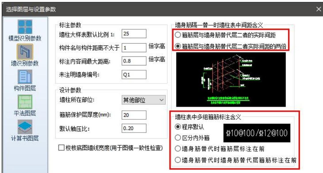
当墙柱箍筋考虑墙身筋隔一替一时，对于墙柱表中表达的箍筋间距的含义增加参数控制。
