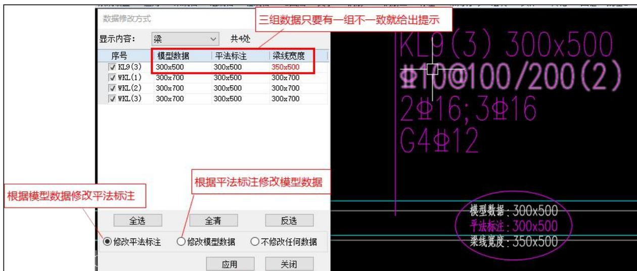
图模一致性检查结果中可以实现根据模型数据修改平法标注、根据平法标注修改模型数据，但是不能实现底图上梁线或墙线宽度的修改。
