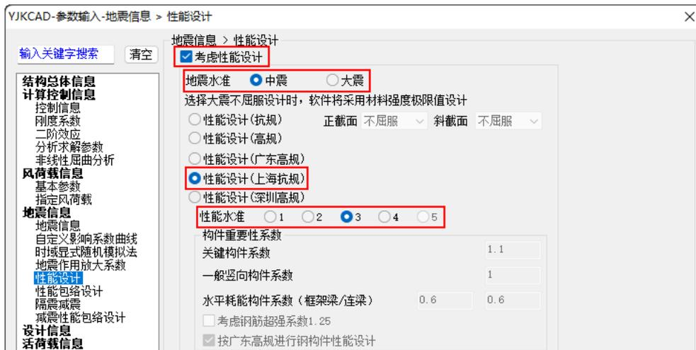
软件中，在“计算参数”-“性能设计”中选择性能设计（上海抗规），“地震水准”可以选择“中震”或“大震”，“性能水准”可分别选择“1、2、3、4”和“2、3、4、5”。
