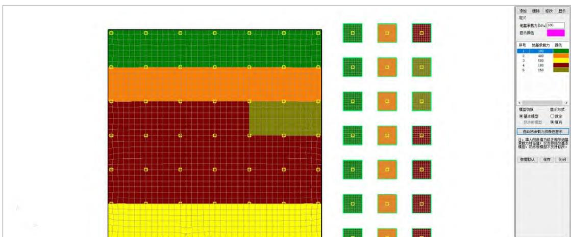
需要注意，该功能所显示的默认值以及手工修改的数值，均为深宽修正前的原始地基承载力特征值  $f_{ak}$ ，当使用该功能修改完地基承载力之后，程序在计算时将自动进行深宽修正，并在“地基承载力验算”功能中输出修正后的承载力计算结果。
