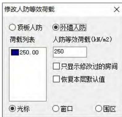
5、层间板支持人防荷载的布置：设置人防荷载后，可选中层间板设置顶板人防荷载。
