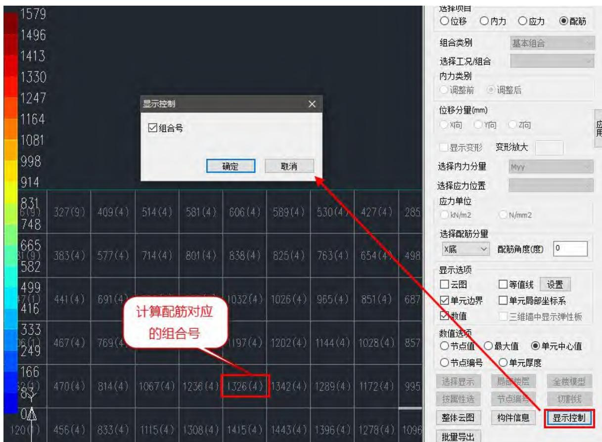
在楼板施工图中勾选“取整体计算弹性板结果”时，查看弯矩值时会同时输出控制计算配筋面积的弯矩对应的组合号，方便用户在设计结果等值线中对弯矩结果进行查看。
