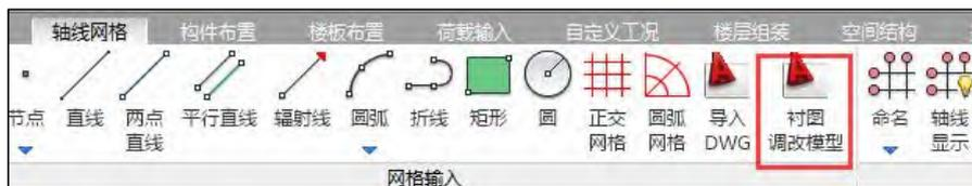
在已有的模型中插入衬图，可通过衬图图层与对应位置的构件进行位置比对，一键完成构件与衬图的自动对齐，如下图所示，执行【衬图调改模型】命令后，框选整层模型，即可完成全部构件与衬图的对齐。
