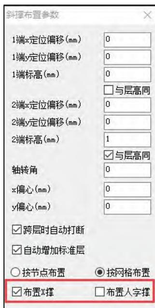
布置 X 撑方式有两种：按节点布置、按网格布置。可布置单层交叉斜撑，也可布置多楼层的交叉斜撑。按网格方式布置只能布置单层交叉斜撑，选择一根网格后，软件自动在网格上生成 X 撑，如下图所示：
