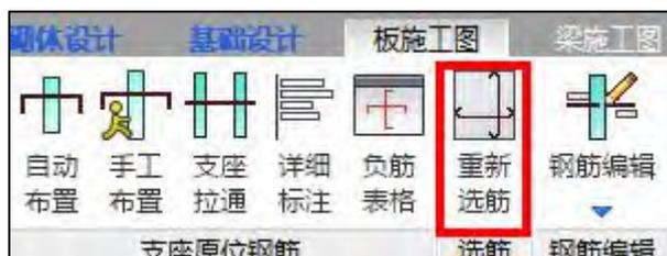
当楼板参数中的部分选筋参数发生变化后，可以不重新进行楼板计算，只需要根据已有的弯矩计算结果进行实配钢筋的重选即可。旧版本中是将计算和选筋一起完成的，对于平面较大的功能，重复计算耗时较长。所以新版本中将选筋独立出来，解决了整个平面重复计算的效率问题。
