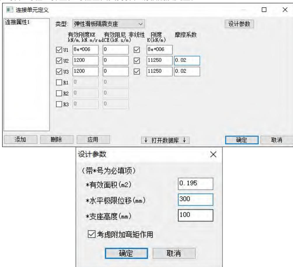
反应谱分析支持弹性滑板支座的等效参数迭代计算和复振型算法，输出等效参数、隔震层偏心率和支座应力、位移等
