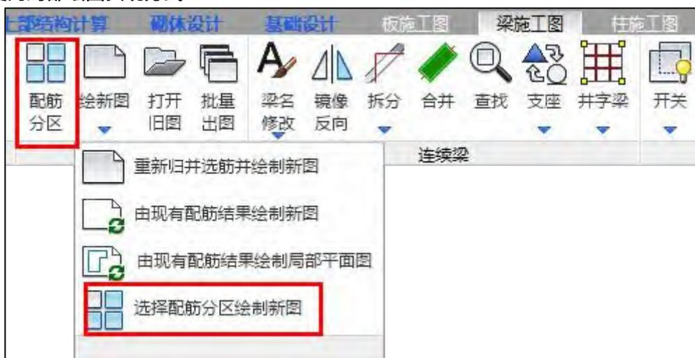
在绘图菜单中增加【配筋分区】定义功能，并且在绘新图下拉选项中增加【选择配筋分区绘制新图】。全新的局部绘图实现方式，解决了地下车库与主楼分区域绘制的问题，同时可以实现分区域的归并编号的需求。
