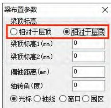
选择相对于层底，若梁顶标高1/梁顶标高2值按默认0值布置，自动布置在层底位置，如下图所示，标高值从层底位置计算，正值为层底向上高度处的层间梁，如下图所示：
