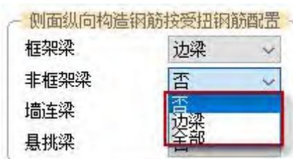
该参数控制梁侧面纵向构造钢筋是否强制按照受扭钢筋配置，选择“否”，程序会自动根据计算结果中是否有计算抗扭所需的纵筋来判断；选择“边梁”，对于一侧有板的梁腰筋均强制按照“N”配置；选择“全部”，则将全部梁的腰筋均按照“N”配置。
