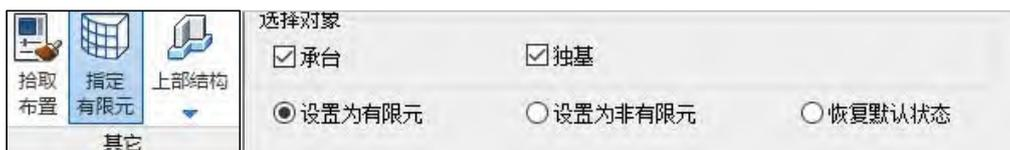
**默认状态：**默认状态指创建基础模型过程中，不对承台和独立基础的有限元状态修改，程序可以根据计算参数设置以及承台、独立基础与筏板、地基梁、墙柱等的接触关系自动修改有限元状态参数，进而以默认的方式决定是否采用有限元计算。
