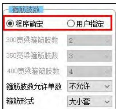
可以选择程序确定，或用户指定两种形式。选择程序确定时，是由程序根据肢距自动确定箍筋肢数；选择用户指定时则使用下列梁宽设置的箍筋肢数值。
