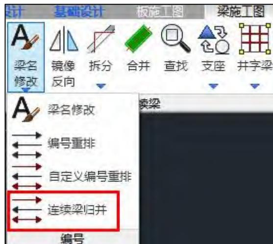
增加连续梁手动归并的功能，执行【连续梁归并】后，根据命令行提示，第一步选择归并数据源连续梁（即归并是配筋的参考对象），第二步选择目标连续梁，确认目标连续梁选择完成后，程序根据几何特性是否一致（比如梁属性、截面、梁跨数、支座类型、各跨分段数及各段长度等），判断是否具备强制归并为一组的条件，如果满足则将选中连续梁按照源对象的编号及配筋，如果不满足则不能归并。
