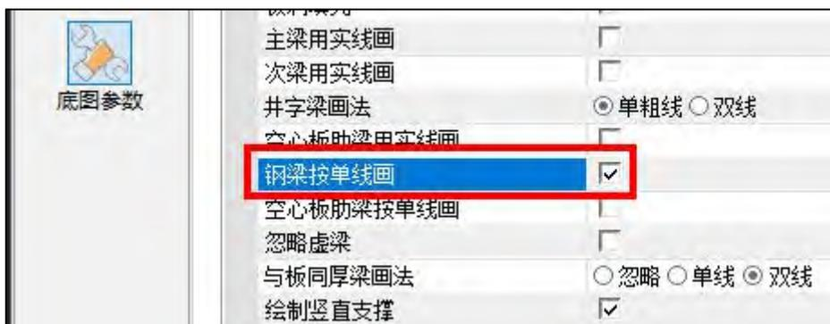
在底图设置参数中增加钢梁是否按单线绘制的控制参数，如果选择按单线绘制，则绘制形式与钢结构施工图的类似，并且通过三角表达钢梁的支座形式是否是固接，如下图所示。
