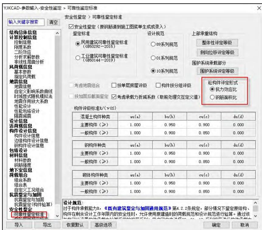
选择钢筋面积比时，程序按照“实配钢筋面积/计算钢筋面积”的比值进行混凝土构件承载能力项评
