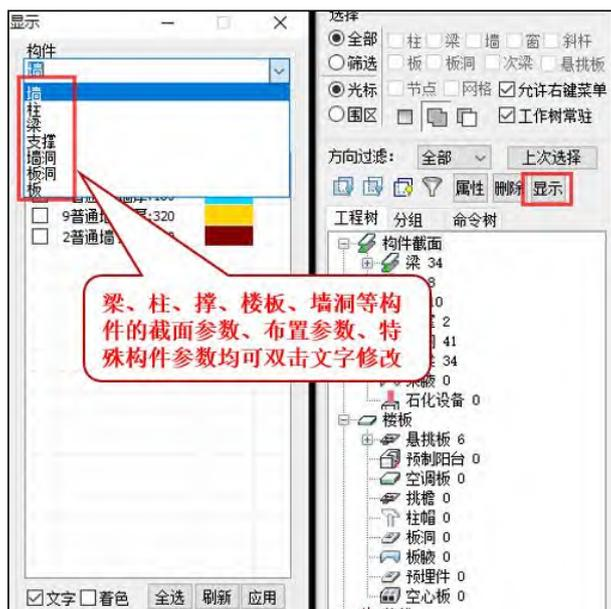
选择构件对应的参数，勾选后模型窗口中显示该参数对应的文字，可双击修改，如下图所示，双击混凝土标号文字直接修改完成材质的修改：
