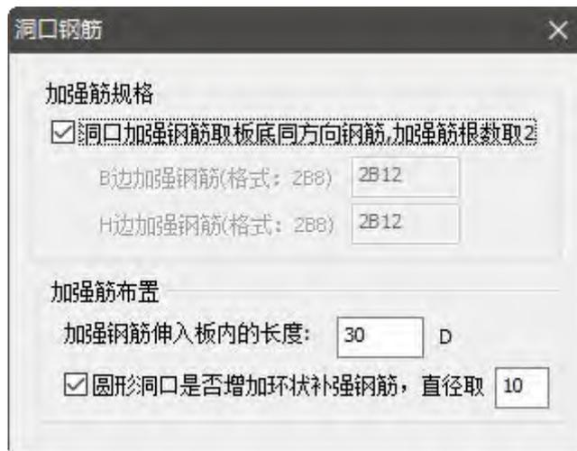
然后在平面图中用光标点取规则洞口，程序自动根据设置值绘制出洞口补强筋，如下图所示。
