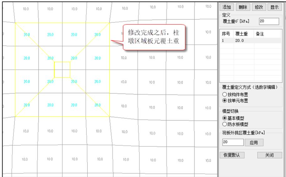
总结为以下几条：1、柱墩覆土重初始值同建模中定义的筏板覆土重；2、筏板和柱墩按构件设置时分开独立布置，按构件修改筏板覆土重时不再修改柱墩覆土重；3、柱墩修改机制同筏板内独基和承台，按构件修改完成后柱墩相关板元覆土重会跟着修改，此时如果执行“生成数据”，按构件布置下的柱墩覆土重显示数值会恢复成默认值，但柱墩板元中覆土重依然会保留修改的数值。
