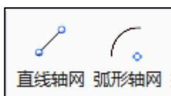
其中直线轴线采用两点式绘制方法，圆弧轴线可选择下图所示四种绘制方式。
