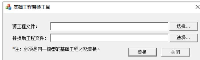
使用时注意两点：1、替换后，目标工程中的基础模型被覆盖、且不可撤销，替换前注意备份目标工程；2、源工程、目标工程的上部结构模型需保持一致。
