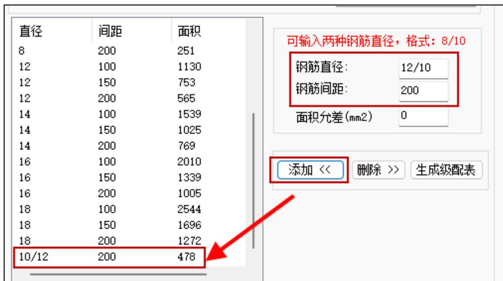
手动添加钢筋级配时，钢筋直径允许输入d1/d2的形式，然后将相关组合级配添加到级配库中，在自动选筋时只要该级配下对应的面积符合计算面积的选筋条件即可选取，如下图所示：
