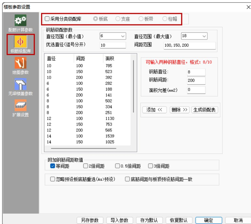
楼板钢筋级配库设置支持两种形式：（1）各类钢筋采用统一的钢筋级配库；（2）各类钢筋采用单独的钢筋级配库定义。当勾选“采用分类级配库”时，可以分别设置板底钢筋、支座钢筋的级配库，对于无梁楼盖，还可分别设置板带钢筋和柱帽补强钢筋的级配库。分类级配库的设置用来实现对不同类型钢筋选筋的单独控制。
