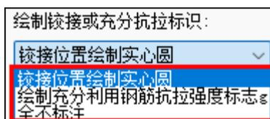
在梁施工图中可以通过实心圆标注出前处理中定义的梁端铰接位置。尤其是对于一端铰接一端充分利用钢筋抗拉强度时，可以通过该参数来区分。
