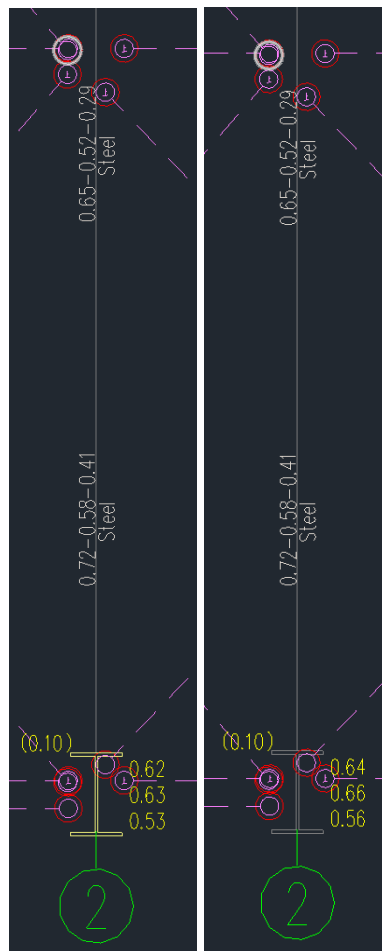
图 12 典型标准榀柱是否定义为门式刚柱应力比变化（右图为柱定义为门式刚柱结果）
