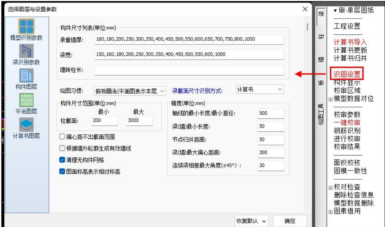
识图设置中包括模型识别参数、构件识别参数、构件图层、构件平法标注图层、计算书图层五组。
