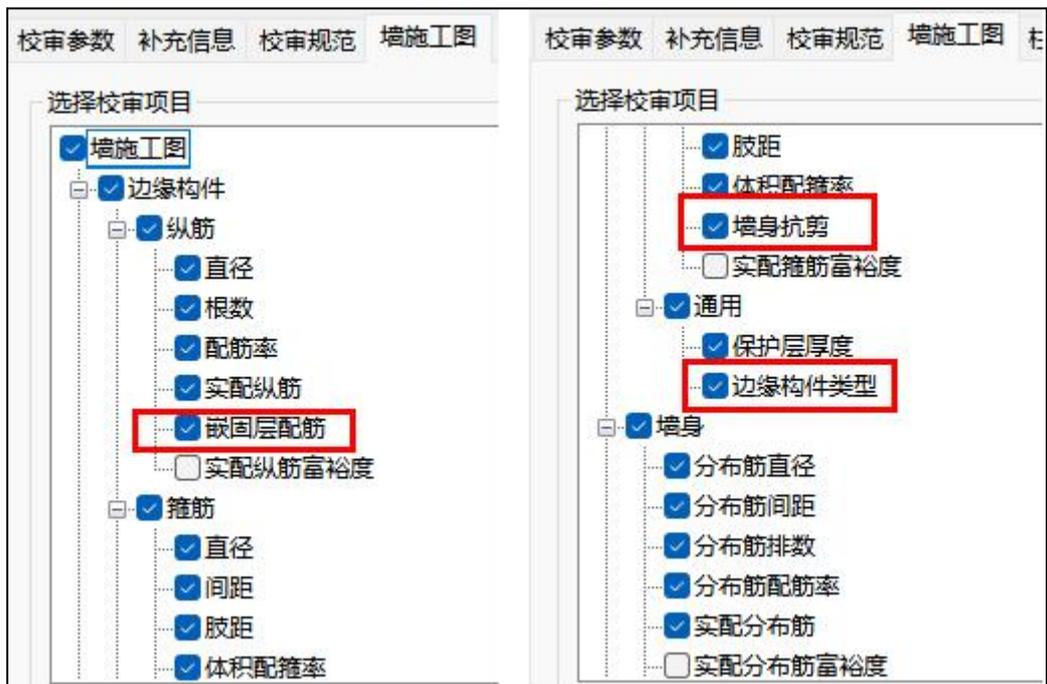
**墙身抗剪：**对于整个墙肢都被边缘构件包住的情况下，除了按照边缘构件箍筋进行校审外，还会校审箍筋是否满足墙身抗剪的要求。
