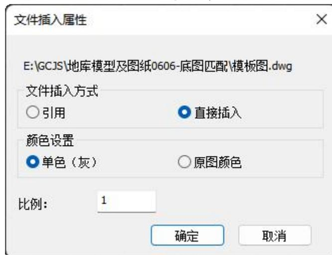
模板图的插入方式支持两种形式：引用、直接插入。“引用”即将DWG文件按照外部参照的形式插入到当前窗口中；“直接插入”即将选择的DWG文件中的所有图素插入到当前CAD窗口中。
