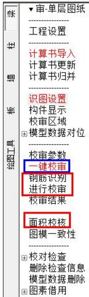
点击【一键校审】或【钢筋识别】时会弹出下图所示对话框，如果是单层的校审则直接设置当前层层高即可（层高的设置是为了考虑后续柱施工图校审时柱子剪跨比的计算），如果是不同标准平面的校审则可以根据工程信息中已经设置好的标准层进行楼层切换。
