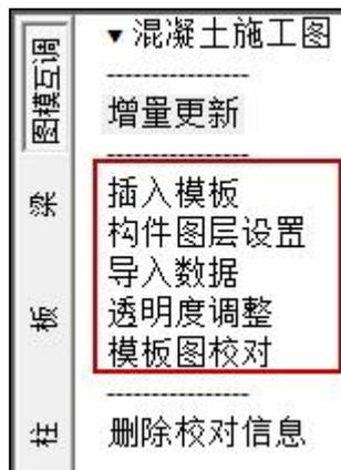
模板图校对是识别用户模板图上已经绘制好的构件（梁、柱、墙），与设计使用的模型进行对比，比较两者的差异，并使用用户绘制的模板图校正模型数据。
