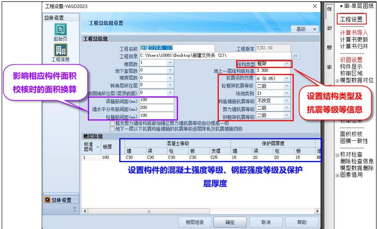
在工程信息页中需要完成一些基本的信息设置，如果不需要程序按楼层保存校审数据，此时可以不创建楼层，按照默认的单层模型进行识别及校审即可；如果需要对校审过的平面能随时查看校审结果，则可以按照平面个数创建相应的标准层数，通过界面下方的【楼层组装】按钮，在弹出的楼层组装界面上创建标准层即可。
