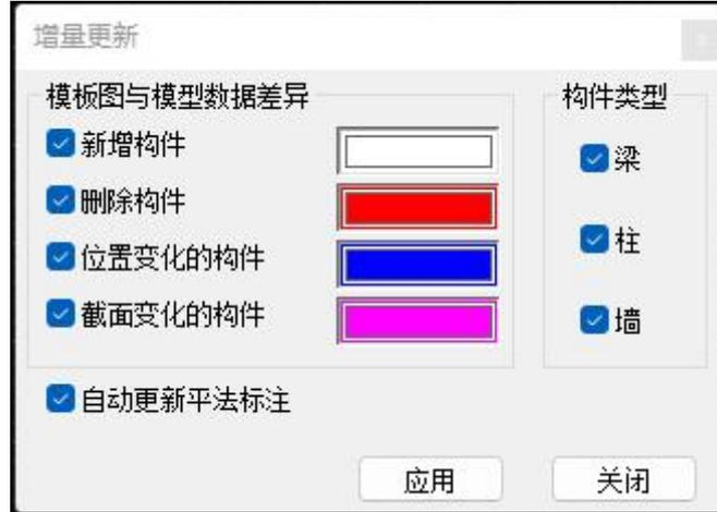
增量更新在点击应用时可以实现两方面的调整：（1）底图会根据最新的模型数据重新绘制；（2）对于有变化的位置构件的配筋会根据新的数据自动调整并更新。
