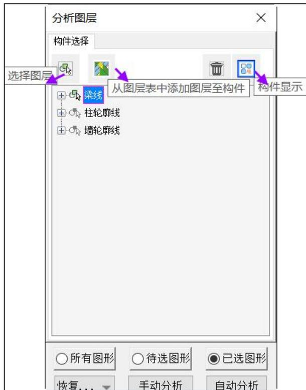
执行构件图层设置时弹出上图所示对话框，在该对话框中需要完成对模板图中构件图层的设置，包括梁线图层、柱轮廓图层、墙轮廓图层。
