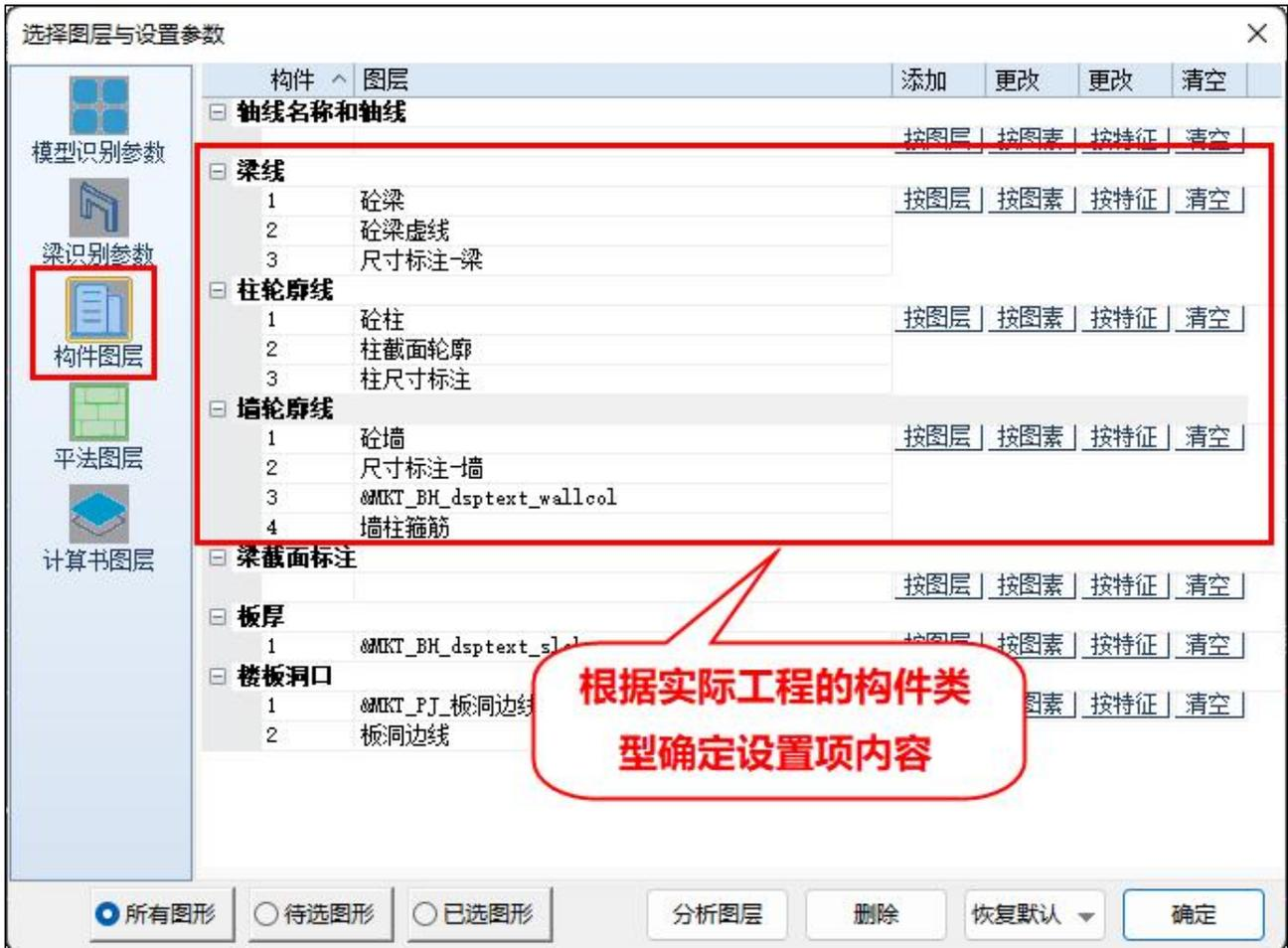
各个构件的【平法图层】的设置中需要完成对平法标注图层、表格相关图层的设置。该设置是为了识别用户图纸中的钢筋信息使用。
