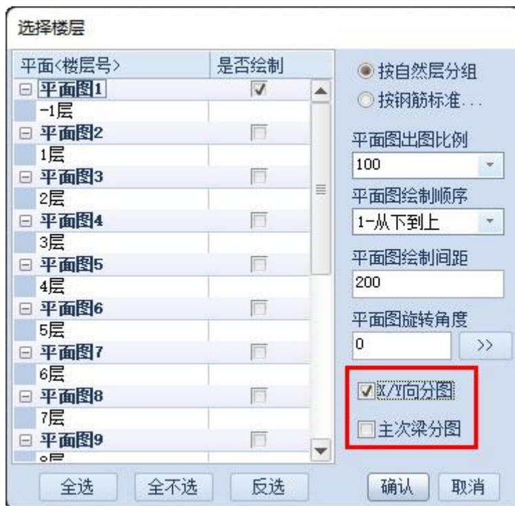
绘制平法图时，在绘图界面上增加了选项“X/Y向分图”、“主次梁分图”，可以直接选择是否分图绘制。如果选择了分图绘制，则底图绘制、配筋归并、梁平法图绘制各步操作中都会按照分图进行相应的选择。如下图所示：
