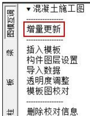
增量更新是用来检查已生成图纸使用的模型数据与最新的模型数据是否一致，如果不一致，则在已生成的平法图上给出提示，检查内容主要包括以下四项，见下图所示：（1）新增构件的提示；（2）删除构件的提示；（3）位置变化构件的提示（主要是指构件偏心）；（4）截面尺寸变化的提示。
