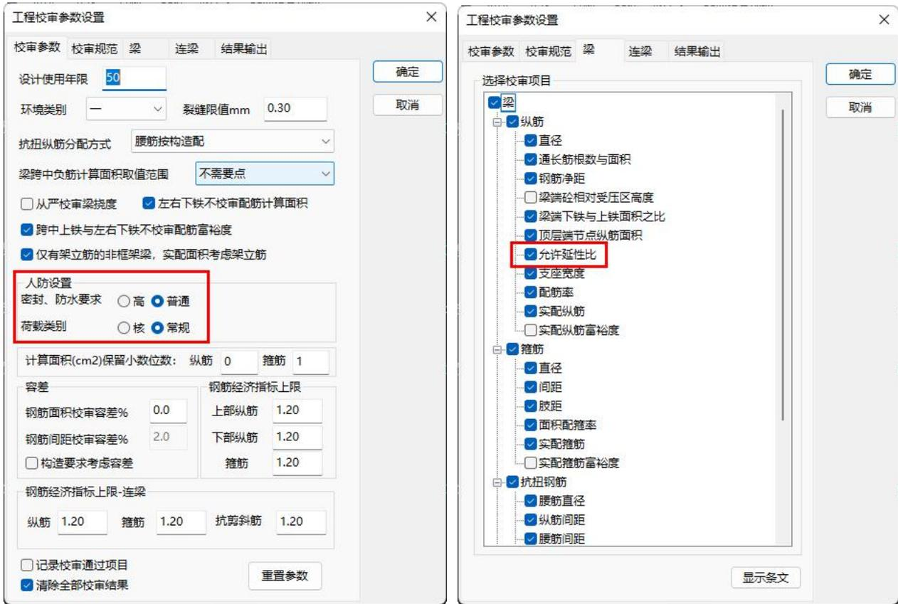
(2) 梁施工图中增加对连梁的识别（包括按框梁建模的连梁及墙洞连梁），并且在校审参数中增加了关于墙洞连梁的校审项。
