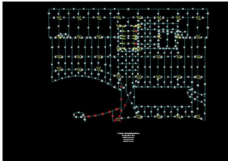
自动分塔的结果可以在计算简图中“自动分塔示意”查看，这个模型第5塔划分的不合理，配筋显红的这位置形成了很长的悬挑梁，分塔配筋出了问题最终导致包络取大后的模型有问题。
