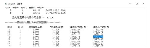
我们再在 wv02q.out 文件中找到所有框支柱的 Y 方向的总剪力 4527.3kN。
