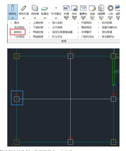
以上图左侧的框支柱为例,构件信息中 x 方向的 kzzx=4.456。
