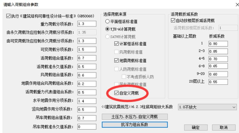
在【土压力、水压力、自定义荷载】下，将自定义恒载工况 FT 进行勾选。
