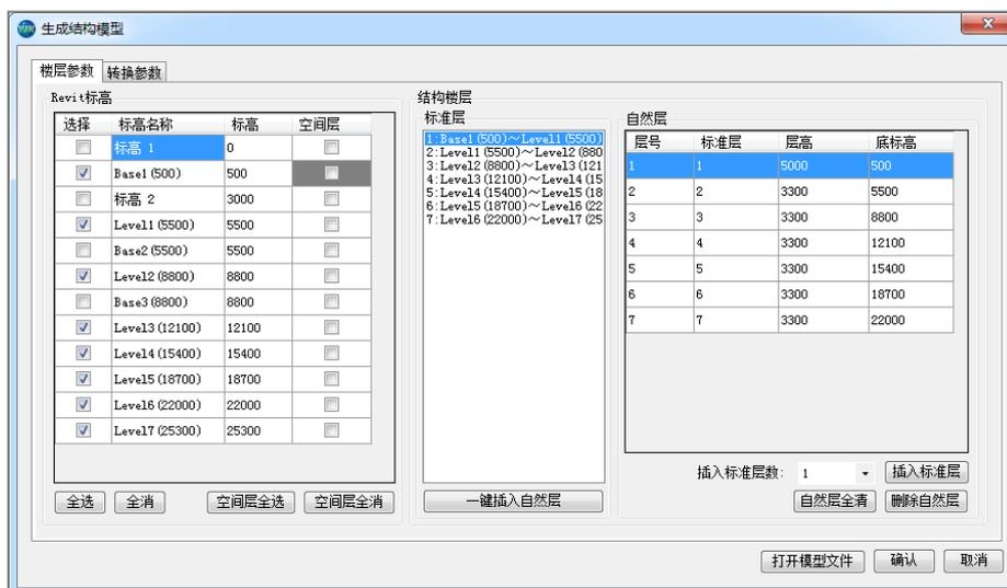
图 4.3.39 模型导出参数
