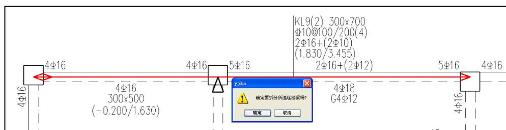
图 7.3.4 连续梁拆分图
