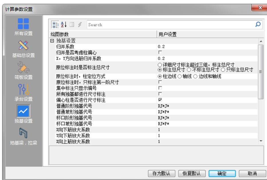
图 10.3.22 独基施工图的控制参数
