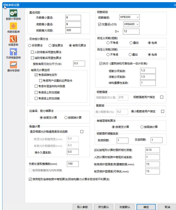
图 6.2.1 楼板配筋计算参数
