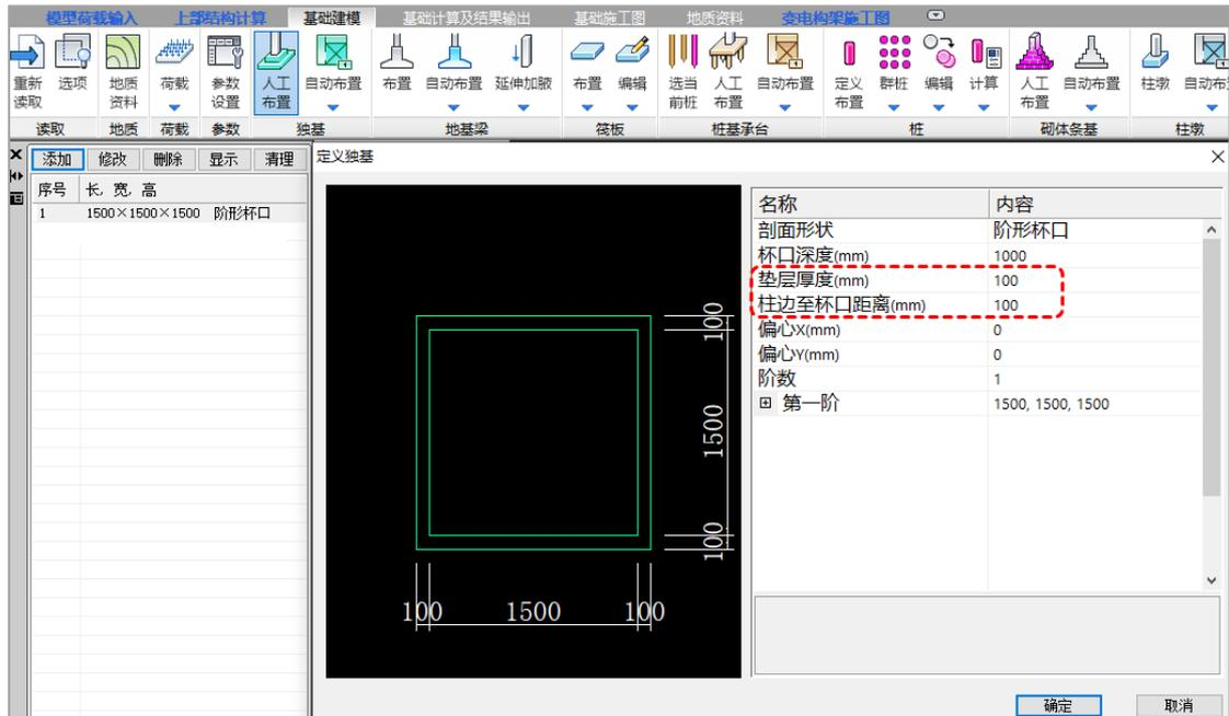
变电构架杯口基础建模可采用筏板+独基的方式布置。筏板尺寸可采用 CAD 放样后直接导入 CAD 筏板快速生成也可以采用画网格布置筏板方式生成，然后筏板上布置独基。注为了计算准确独基底标高和筏板底标高保持一致。
