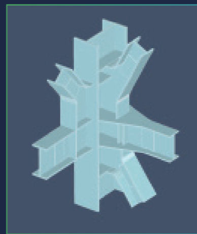
钢结构施工图节点模型
