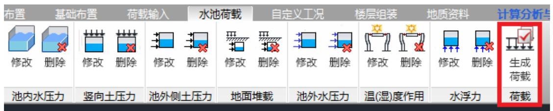
水池荷载添加完成之后，可以进入自定义荷载菜单下进行查看，还可以对需要补充的荷载进行添加，以及对已经布置的荷载进行删除或者修改。有一点需要说明，下面红框中的工况为考虑池内水压自动不利布置后程序自动生成的工况。
