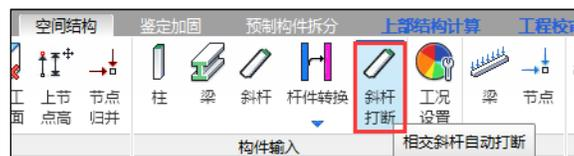
下图所示的桁架交叉斜撑没有打断，执行【斜杆打断】命令后，交叉斜杆全部自动打断：
