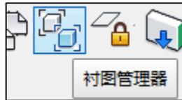
程序在基础中增加衬图管理器功能，当用户在基础中插入多个衬图后，可以在管理器中任意切换不同的衬图，同时可以修改衬图放大系数、旋转角度、亮度等参数。
