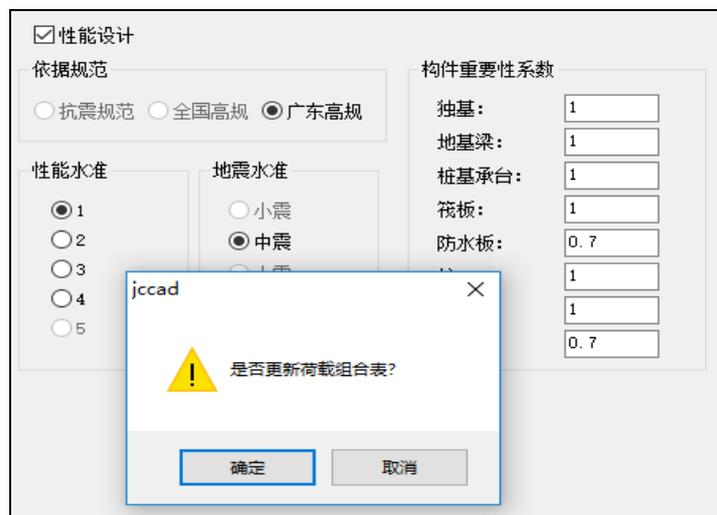
荷载组合系数通过地震力折减系数  $c$  和广东高规《高层建筑混凝土结构技术规程》DBJ 15-92-2020 公式 3.9.5-1 综合考虑等效得到。
