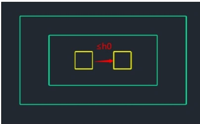
考虑到这个限值条件往往过于苛刻, 导致这个参数对于很多情况下都不适用, 因此在 v3.1.1 中, 程序完全放开了这一限制条件, 只要柱墙在轮廓内, 程序就会按外包轮廓的方式对该独基或承台进行简化计算。
