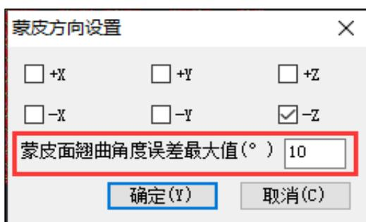
部分空间桁架模型用默认的误差角度  $10^{\circ}$  蒙皮，可能出现部分蒙皮面没有生成蒙皮或生成的异常蒙皮，可根据工程情况适当修改该参数值。
