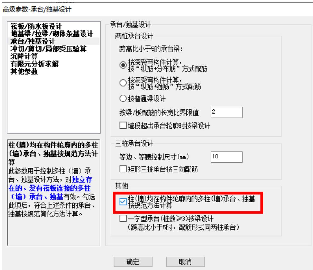
V3.1.0 及以前的版本, 该参数有一个非常不方便的限值条件, 该参数只对柱墙间距在  $h_0$  以内的情况起作用, 如果柱墙相距较远, 距离大于  $h_0$ , 则这个参数不起作用。如下图, 就是一种典型的情况, 只有两柱间距在  $h_0$  以内, 该参数才能生效, 否则依然会按有限元的方式进行计算和设计。
