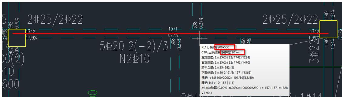
第一排钢筋中心距离梁边的距离:  $D_1 = 20 + 8 + 12.5 = 40.5$  mm
