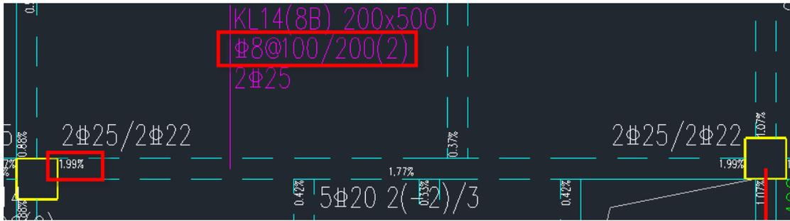
(2) 调整保护层厚度为 30 时，计算出的实际配筋率为 2.04%>2%，选筋结果如下图所示：
