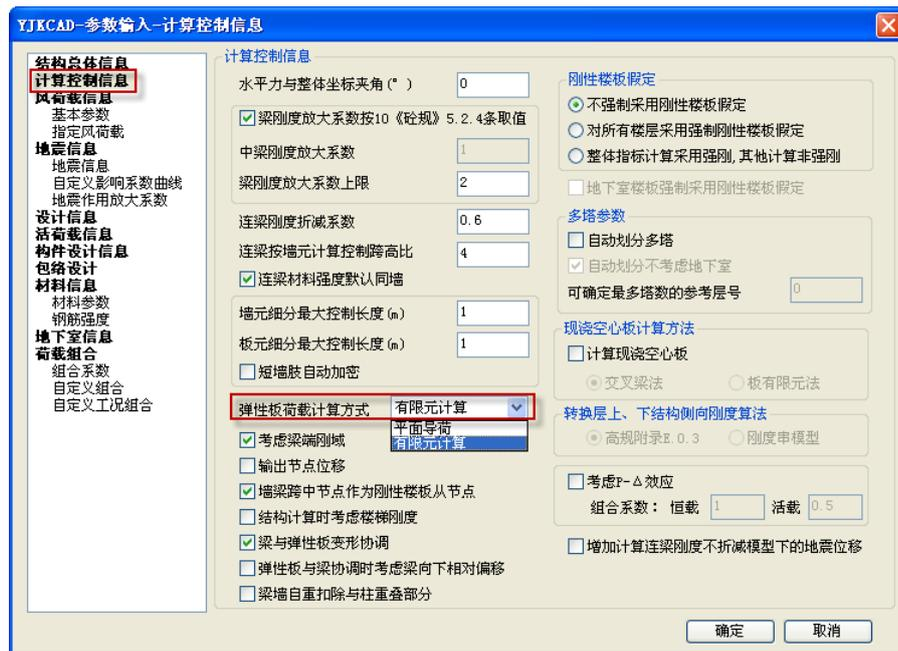
图 3.7.8 弹性板荷载计算方式
