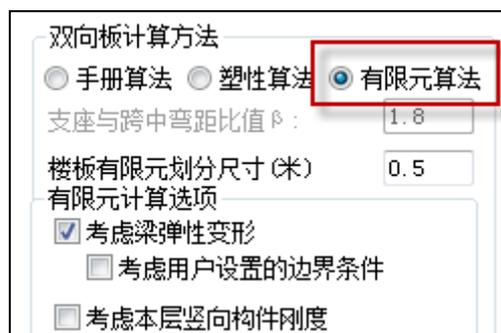
图 3.7.35 板施工图中楼板计算参数
